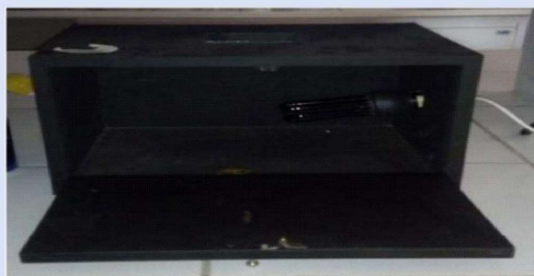
Figura 07: Câmara de raios ultravioleta parte interna
