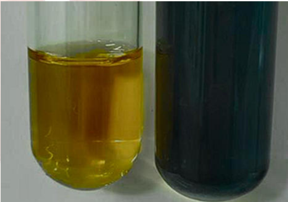
Figura 18. Mudança de coloração da reação de desidratação para identificação de álcoois primários e secundários
