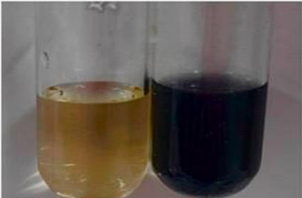
Figura 24. Mudança de coloração na reação complexação para identificação de fenóis
