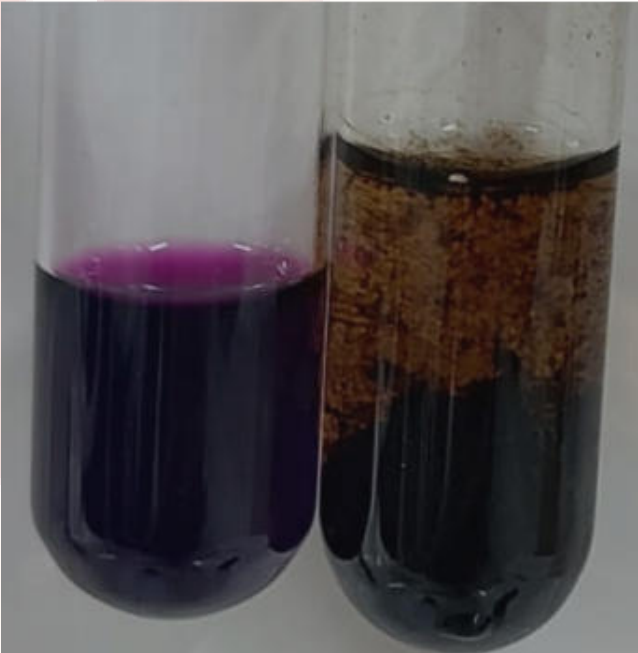
Figura 20. Mudança de coloração na reação de oxidação para identificação de insaturações
