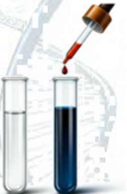
Figura 28 – Reação de carboidratos com o teste de Lugol. Teste negativo para amido (esquerda) e teste positivo para amido (direita) comprovado pelo surgimento da azul escuro.
