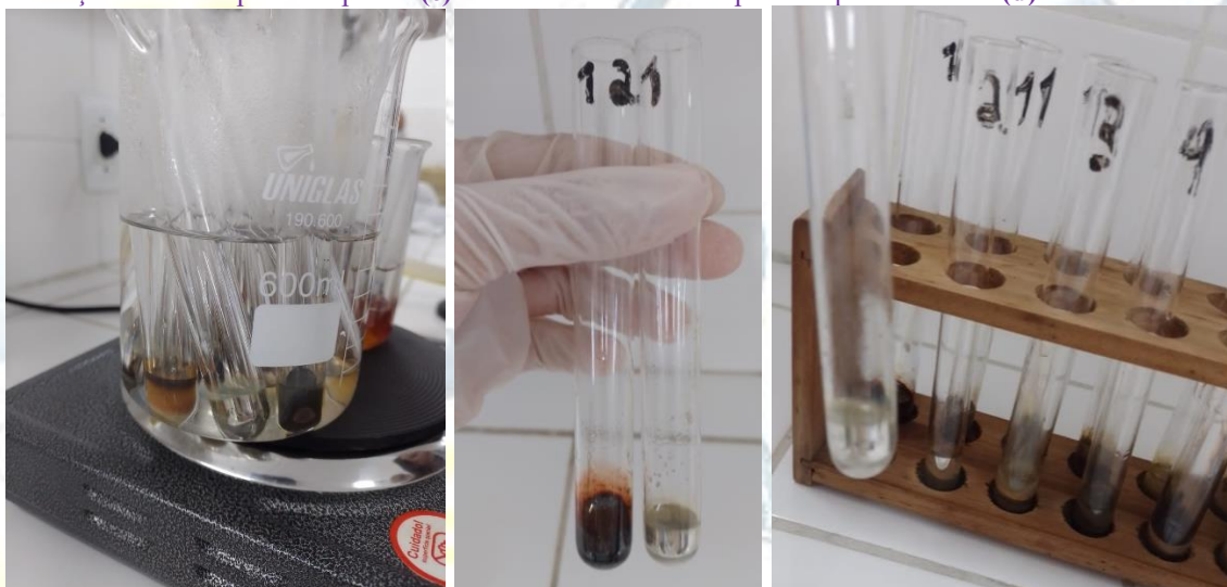
Figura 25. Reação de identificação de aldeídos. (a) Aquecimento das amostras com o reagente de Tollens. (b) Resultados negativos para a amostra da esquerda e resultado positivo para a amostra da direita confirmada pela formação do anel espelho de prata. (c) Amostra com resultado positivo para aldeídos. (d) Resultado das amostras.
